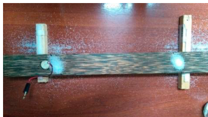
Imagen 9. Identificación de los nodos usando sal
